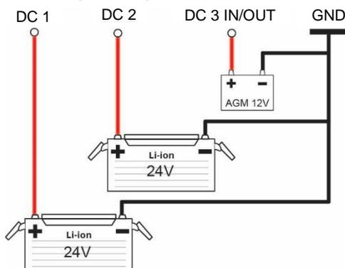
Wenn sich der DIP-Schalter 7 in der Ein-Position befindet, ist DC 3 IN/OUT auf 10 V begrenzt, um eine kleinere Starterbatterie sicher zu laden. Wenn ein 24 V-
