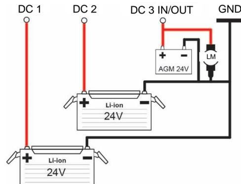
Drei volle Ausgänge. Alle Batterien werden mit den gleichen Einstellungen geladen. DC 3 IN/OUT fungiert als VSR (spannungsempfindliches Relais). Wenn kein Netzstrom verfügbar ist und die Lichtmaschine (Alternator) die Starterbatterie lädt, kann die Lichtmaschine auch zum Laden der Batterien 1 und 2 verwendet werden. Die Konfiguration des Schwellenwerts der Spannung, bei dem umgeschaltet wird, erfolgt über das Konfigurationstool.
